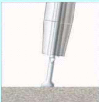
ワイヤーが、溶融プールに浸かると、アークは消える。溶接電流は、一気に下がる。
