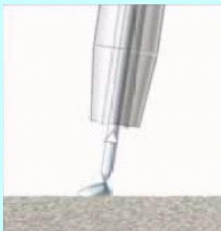
ワイヤーを引き戻すことによって、短絡中の、溶滴切断を支援する。短絡電流は、低いまま。
