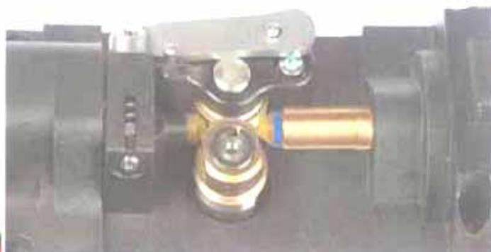
新たな、**テンション・レバー・システム**を、トーチに組み込むことによって、コンスタント、且つ安定した、接触圧力を維持
