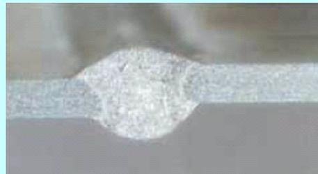
板厚 = 0.8mm のAlMg3 の板材に対して、溶融プール裏当て材なしに、突合せ溶接した、サンプル
