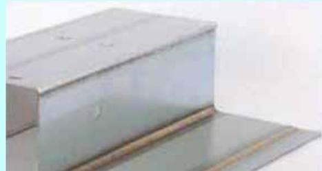
溶融メッキ・シートと、電気亜鉛メッキシートをCMT で、ロウ付けした、サンプル
