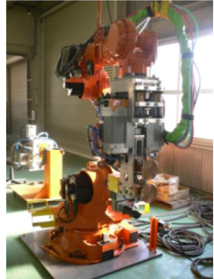
ロボット搭載型シーム溶接機
