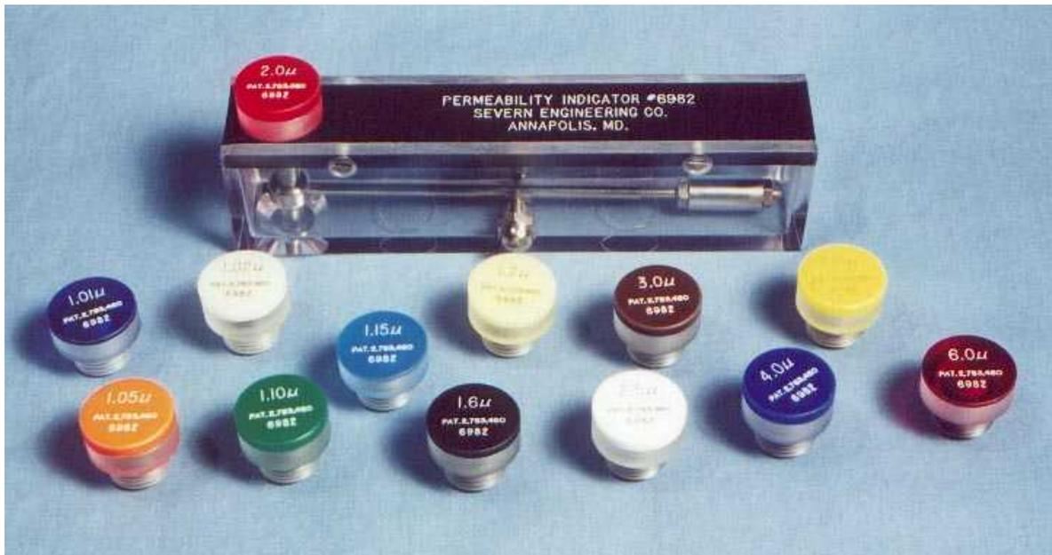
本器は、研究室、工場、現地で使用されるよう開発された、操作の簡単な上、丈夫な非破壊検査器です。オーステナイト系ステンレスとマンガン鋼の溶着金属、母材の合格テスト（受入れ）テストが即座に得られる go-no go（各範囲に入るか、はみ出るか）方式です。本器は外回りに何ら標準を要さず、調節、目盛表示も必要でなく、測定位置により左右されない。薄板、厚板、棒、不規則形状の物、又複雑な部品でも等しく充分検査できます。均質でない製品（被測物）中の透磁率の局部的の高低を効果的に探し出す。また冷間成形や焼鈍処理を必要とする現場でも利用できます。
