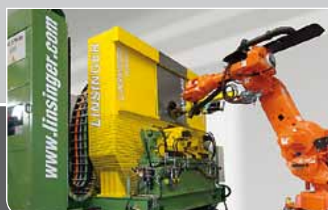
ソー・ブレード交換
