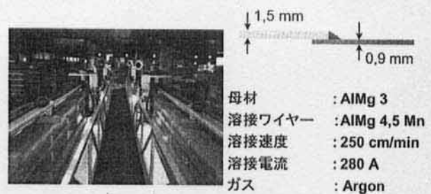
(a) 薄板アルミニウム合板の長尺重継手溶接
