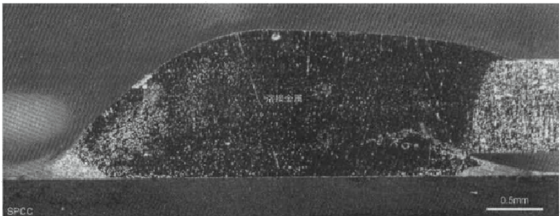
図6 試験片 G (亜鉛めっき厚 t=19 \mu m) の溶接継手の横断面マクロ組織
