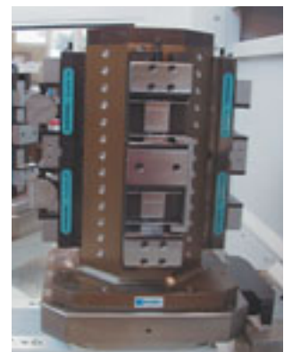
8システムユニット固定の クランピングタワー 横方向の加工の効率化
