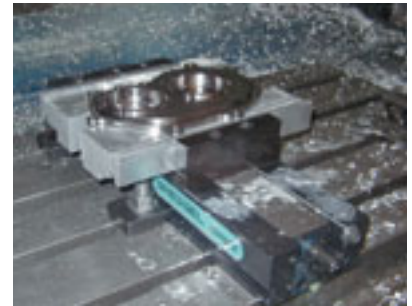
形状治具部品をスペシャル口金で固定
