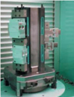
横型マシニングセンタ クランピングタワーに2台の デュオグリップユニットを装着
