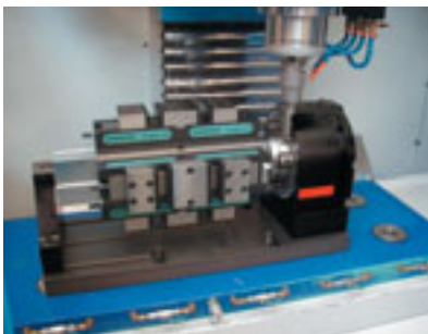
インデックス装置に装着して4軸加工
