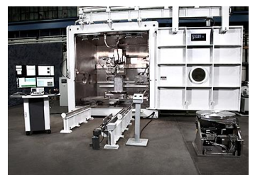
電子ビームを用いた3D積層造形装置
