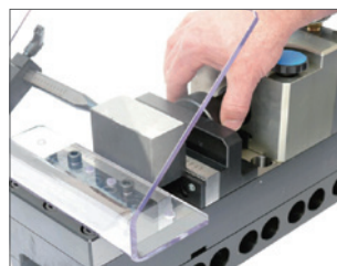
3. 微調整ダイヤルでワークを固定
