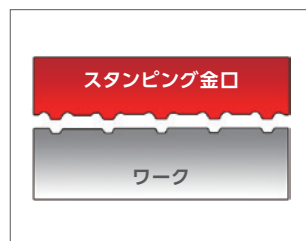
スタンピング口金によるパターン押形 (スタンプフォーミング) のできる凹凸形状の拡大図
