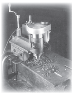
キーミルベース側面に 角を合わせて KM3000 をクランプし、モータ マウント用スロットや ボア穴を切削。
