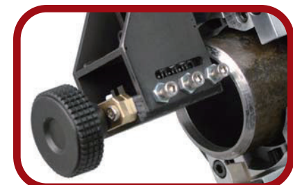
カウンターボアアタッチメントはすべてのモデルのバイトに安全に取り付けられます。
