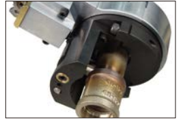
ソケット溶接切断 軸スライド
