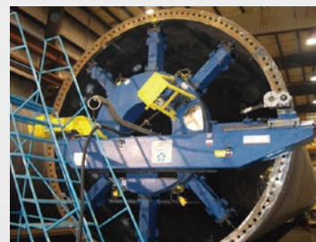
風力タワーのフランジ加工
