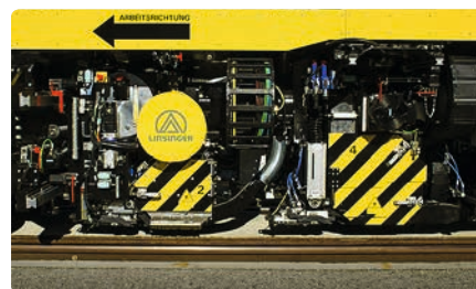
ミリング装置の後にグライディング装置を搭載する事により最高レベルのレール表面品質を達成
