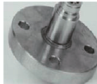
ステンレス 溶接速度=3.6m/min
