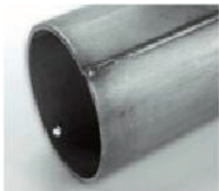
鉄パイプ板レーザ溶接 溶接速度=4.2m/min
