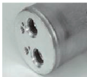
アルミ 溶接速度=4.5m/min
