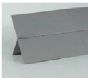
亜鉛鉄板レーザーロー付け 溶接速度=3m/min
