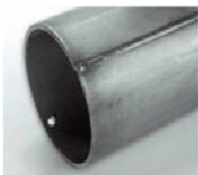
鉄パイプ板レーザー溶接 溶接速度=4.2m/min
