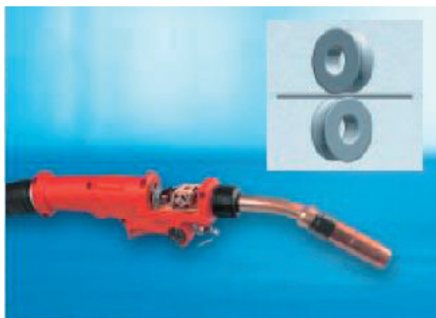
“PT-Drive” プッシュ・プル溶接トーチ： 広範囲にわたり、ドライブ・フォースがかかるので、優れたワイヤー送給が実現し、アルミのようなソフトなワイヤーでも、問題が出ない。
