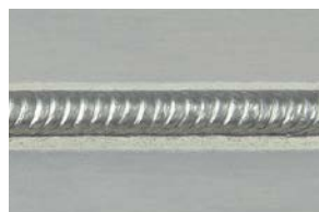
材質:2mm アルミニウム
