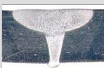
▲ロボットでのプラズマ溶接システム例 10mm 以上の板厚でも 2 パスで溶接できます
