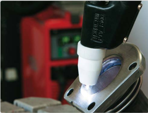
▲ パイプとフランジのすみ肉溶接例 TIG 溶接により溶接速度が 20%アップします。
