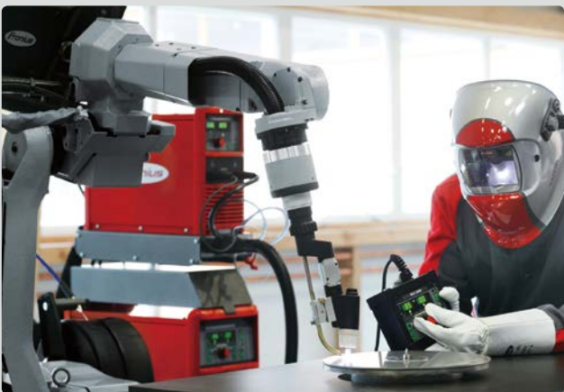
▲ロボットでのプラズマ溶接システム例 10mm 以上の板厚でも 2 パスで溶接できます
