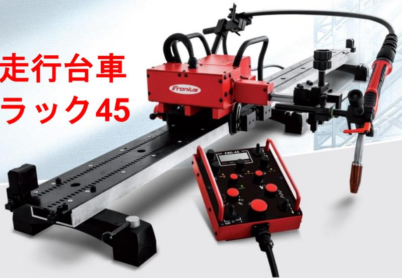
幅広い用途で使用できるコンパクト設計の溶接用走行台車と用途に応じた3種類のガイドレールをご用意しました。多種多様な溶接作業を取り扱う産業（造船、タンク容器製造産業等）では、フレックストラック45があらゆる要望にパーフェクトに応えます。
