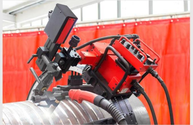
円周溶接中のアーク電流制御による平行直線式オシレーション
