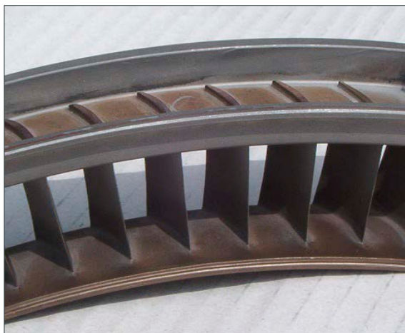
重電機器用プレート肉盛補修
