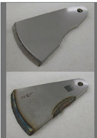
切断ディスクのコーティングと部分補修
