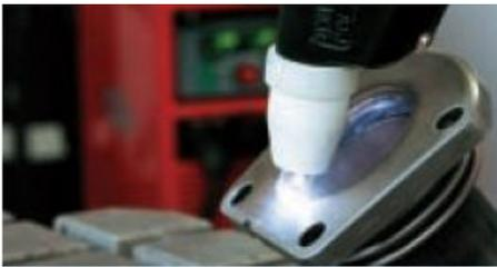
フランジとパイプのジョイントが、ソフト・プラズマを使って、溶接されている
