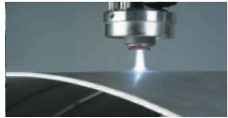
タンクの製造に、プラズマ・キーホール溶接が使われる
