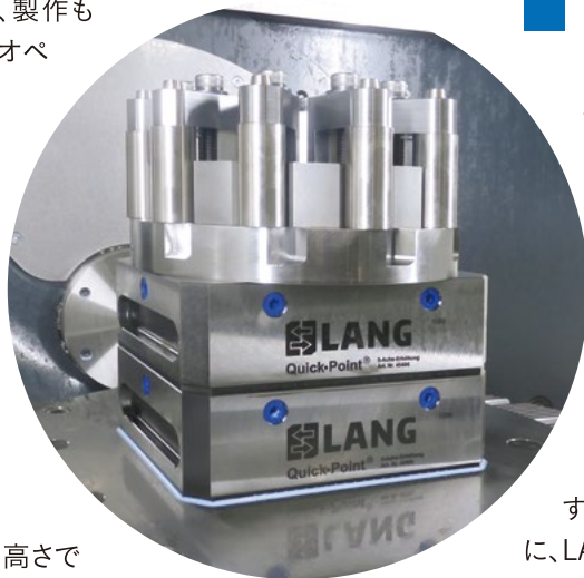
内製ジグと「クイックポイントプレート」を組み合わせた
