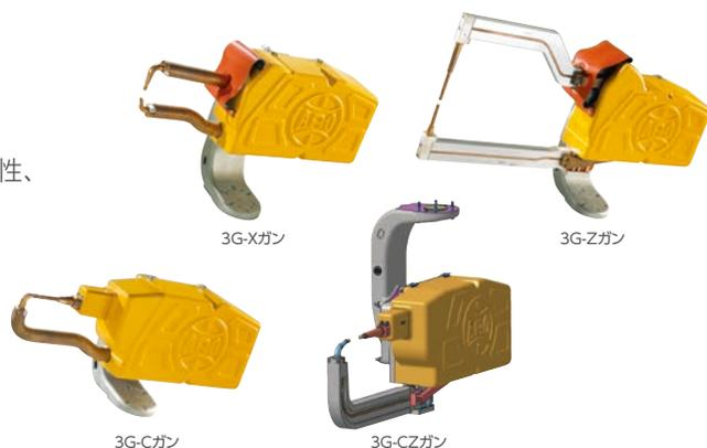
モジュール構造で交換・組立時間を大幅に短縮
