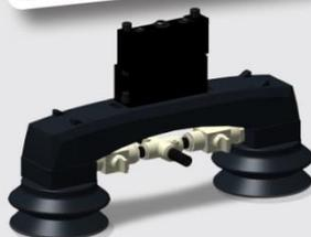
ほとんどの場合、非磁性体 (アルミやステンレス鋼等)、表面が滑らかで磁性のないワークピースに使用します。適用温度範囲は 0~120 °C です。オプションで -30~250 °C にも対応します。
