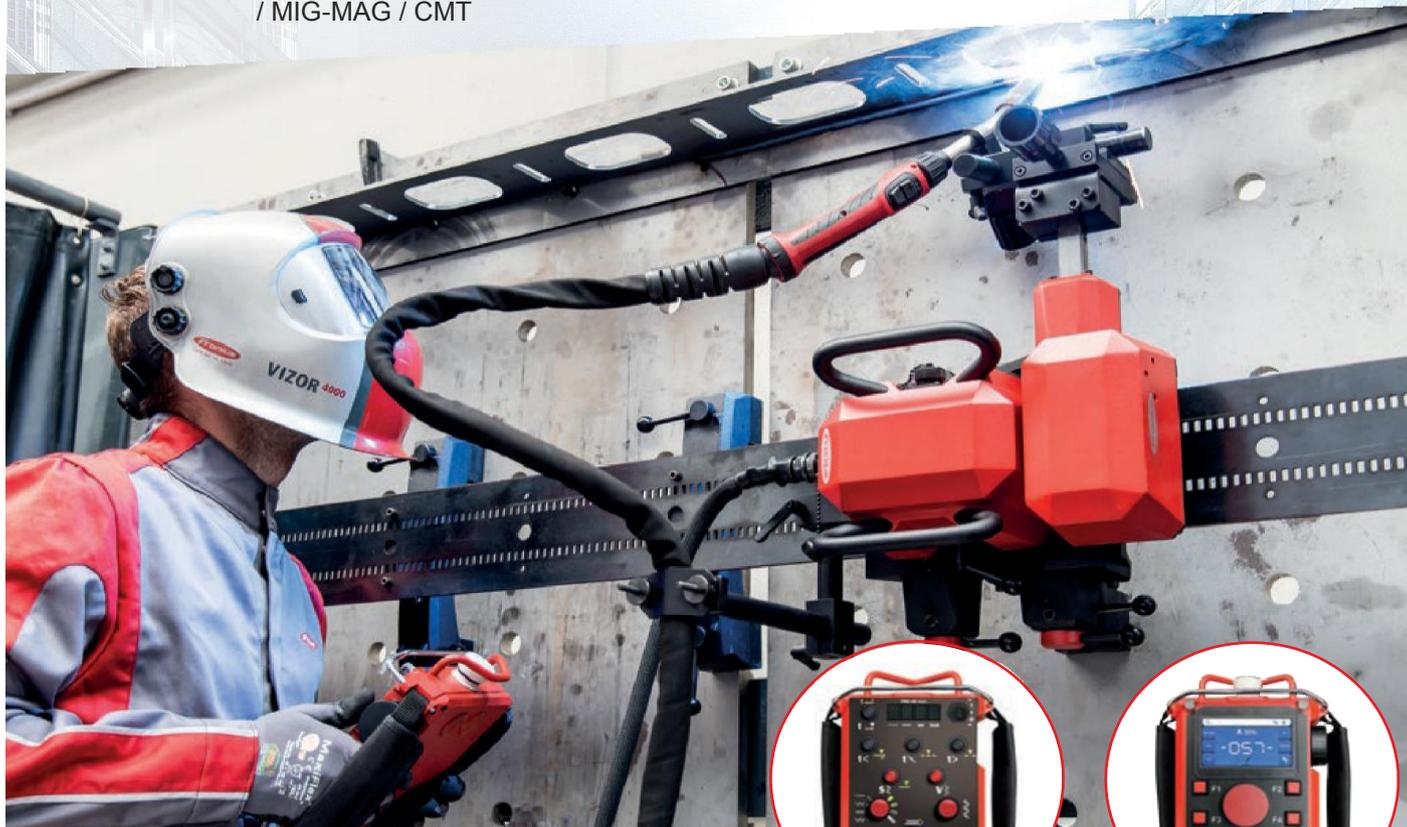
幅広い用途で使用できるコンパクト設計の溶接用走行台車と用途に応じた3種類のガイドレールをご用意いたしました。多種多様な溶接作業を取り扱う産業（造船、タンク、容器製造等）では、フレックストラック 45 PRO があらゆる要望に応えます。
