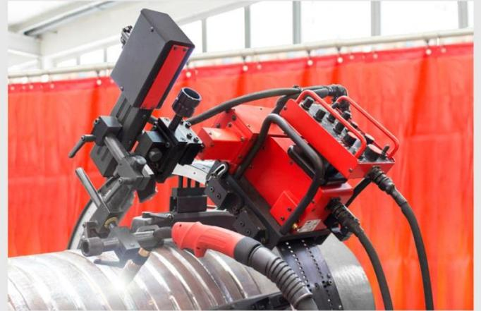
円周溶接中のアーク電流制御による平行オシレーション
