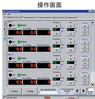
MAXsa™ 10 コントローラと同様の操作をパソコン上でできます。
